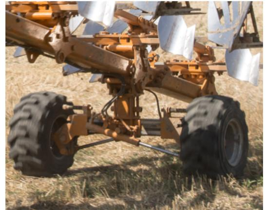
Перевод из плуга из рабочего положения в транспортное совершается с помощью гидропривода. На прицепном устройстве имеется особая поворотная головка, благодаря которой на дороге плуг ведет себя как обычный прицеп.
