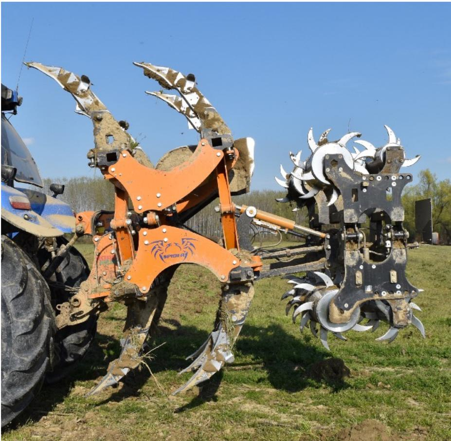
Глубококорыхлитель “SPIDER Compact System” может использоваться как самостоятельное орудие, так и в комплекте со специальными спаренными катками “RCX”. Регулировка глубины работы имеет гидравлический привод. Передний каток имеет диаметр 360 мм, а задний – 220 мм. Эти катки хорошо крошат почву и выравнивают ее поверхность. На ней не остается характерных бугров, которые бывают видны при работе глубококорыхлителей с катками меньших диаметров.
