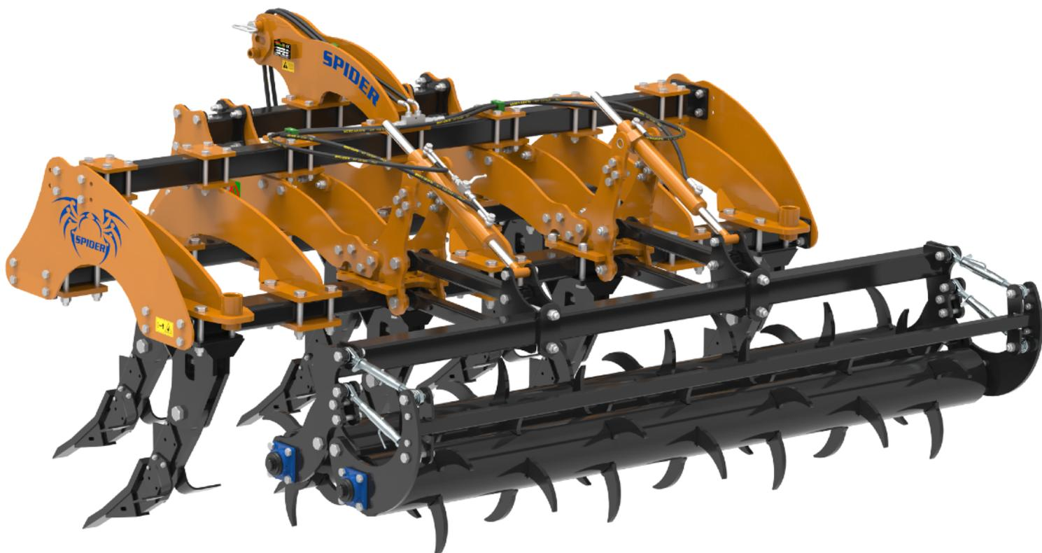
Линия G может также комплектоваться системами складывания COMPACT SYSTEM и защиты от камней STONE SYSTEM.
