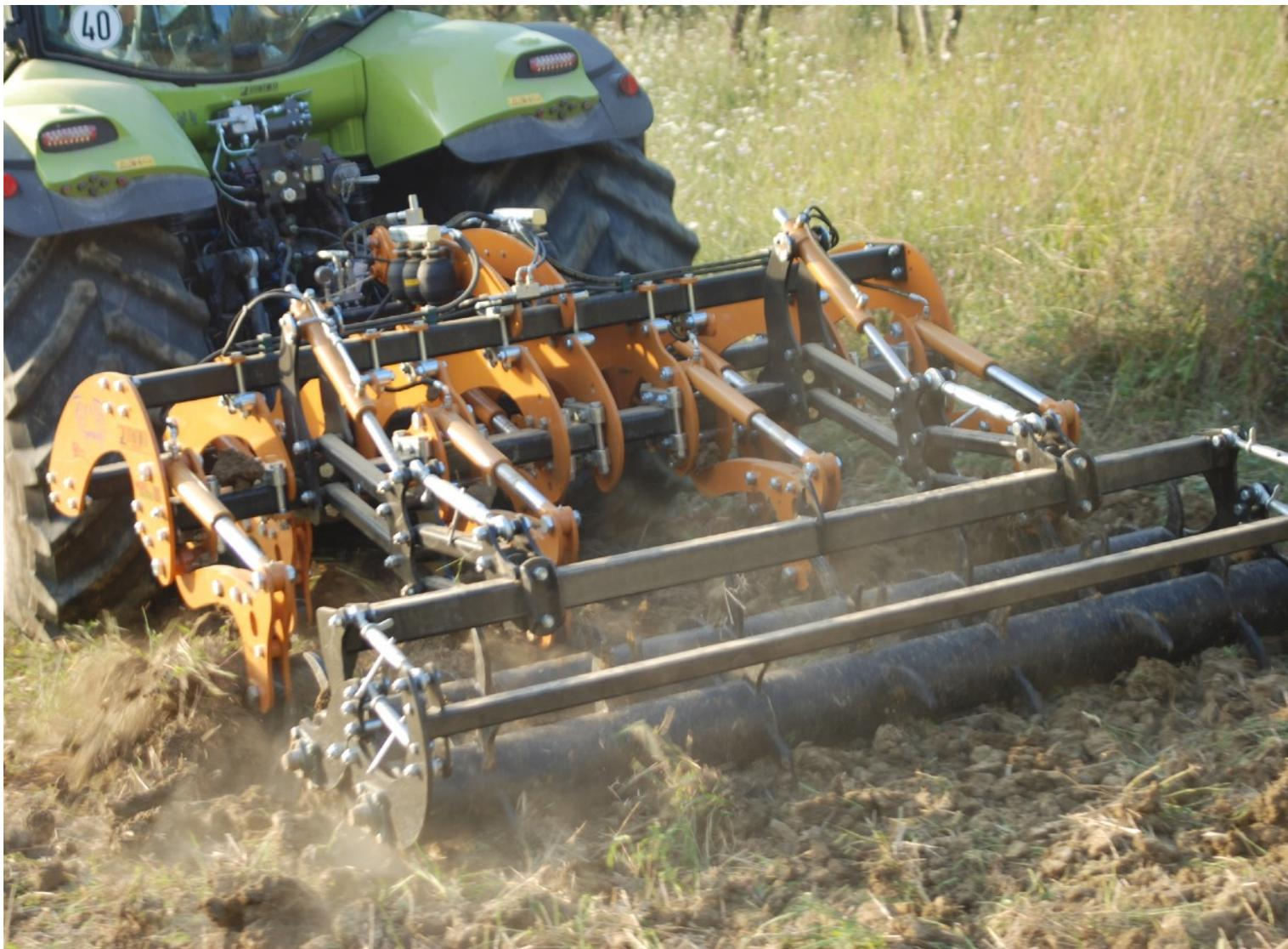
То, что важнейшая задача защиты всей системы выполняется аккумуляторной батареей с непрерывным подзарядом, а не одним аккумулятором, является дополнительным преимуществом данного плуга с точки зрения его надежности. Система SPIDER STONE SYSTEM способна продолжать свою работу даже если выйдет из строя один или несколько аккумуляторов.
