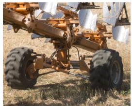
Перевод плуга из рабочего положения в транспортное совершается с помощью гидропривода. На прицепном устройстве имеется особая поворотная головка, благодаря которой на дороге плуг ведет себя как обычный прицеп.
