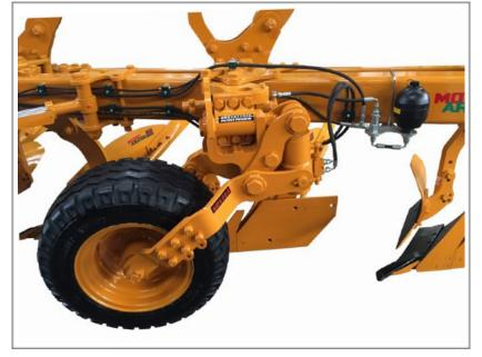
Колесо может устанавливаться в 2 различных положениях:
